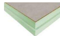
El THERMOBETON es un panel de poliestireno extruido revestido de una capa de 10mm de cemento con fibras de madera. Se emplea para el aislamiento térmico de los zócalos y muros enterrados, así como el aislamiento de petos en cubierta.
