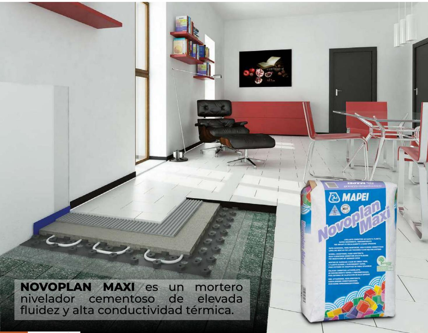
**NOVOPLAN MAXI** es un mortero nivelador cementoso de elevada fluidez y alta conductividad térmica.
