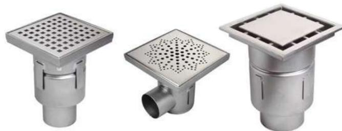
◆ **Sumideros sifónicos** de 150x150, 200x200 y 300x300 mm con cestillo para la recogida de sólidos y salida horizontal o vertical, para tráfico peatonal y pesado.
